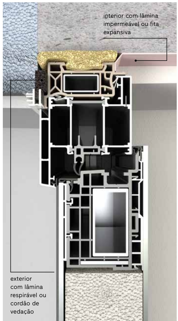
Montagem em duas fases com pré-aro
