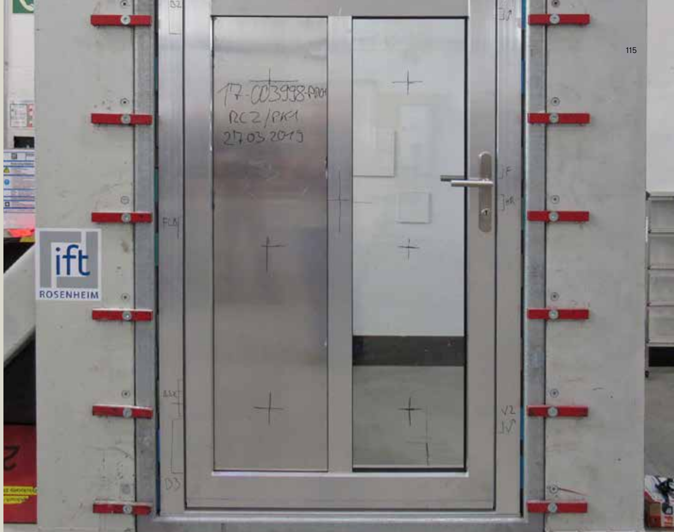
O instituto de janelas (ift) de Rosenheim testa a segurança antirroubo das portas de entrada no banco de ensaios.
